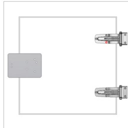
Para o ajuste da peça de fixação, primeiramente aparafuse as duas partes na posição mais baixa. A seguir, se necessário, elevamos a parte superior verticalmente, isto é, movendo-se apenas a parte inferior à esquerda (conforme mostrado na imagem) até que a configuração da porta esteja correta.
