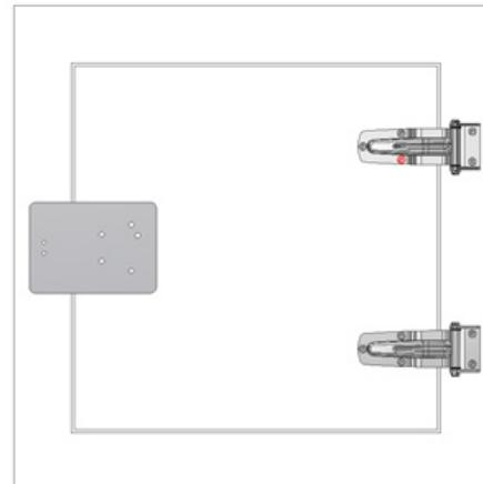
Pour ajuster la pièce d'ancrage, en premier visser les deux parties dans la position plus basse possible. Si nécessaire levez la partie supérieure verticale, en déplaçant uniquement la partie inférieure vers la gauche (voir croquis) jusqu'à que l'ajustement soit correct.
