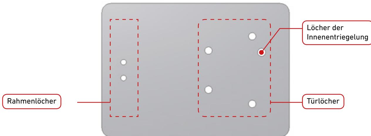
Positionieren Sie die Schablone wie auf der Abbildung gezeigt wird.
