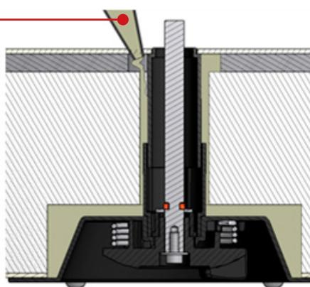
**NOTA:** O design das carcaças permite o ajuste do mecanismo à largura do painel (espessura máxima do painel 100mm):
